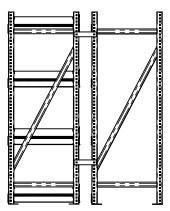
STEP 3 JOIN BACK-TO-BACK FRAMES BY INSTALLING WIDE SPAN **BACK-TO-BACK CONNECTORS** THROUGH SQUARE HOLES IN SIDES OF FRAME POSTS
